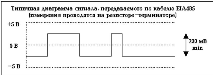
Стандарт RS485 также допускает, что оба провода с данными могут находиться под общим потенциалом смещения относительно нулевого (заземляющего) провода. Потенциал смещения
